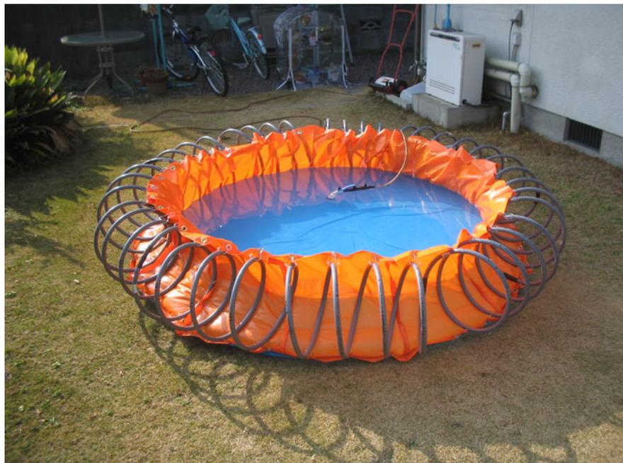
○ 貯水槽（円形プール）模型の注水実験開始（約 25 分経過）
