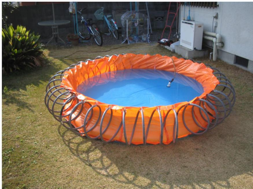
○ 貯水槽（円形プール）模型の注水実験開始（約 30 分経過）
