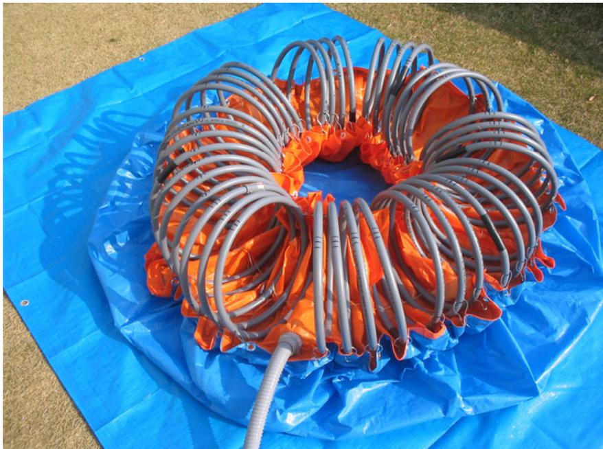
○ 貯水槽（円形プール）模型の注水実験開始直前
