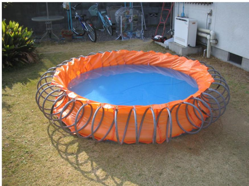
○ 貯水槽（円形プール）模型の注水時螺旋支持具の拡張状態
